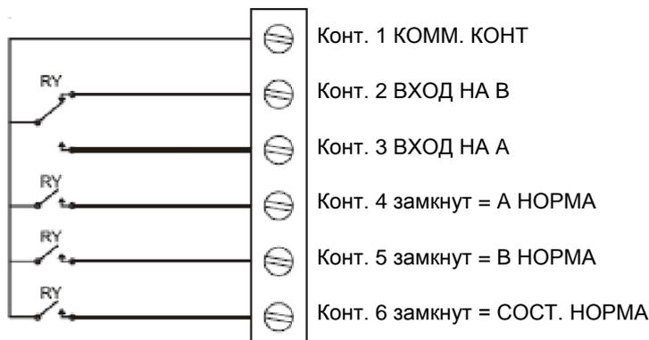
Рис. 2: Базовая схема порта контактов.
